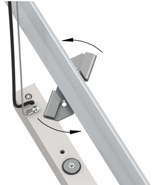
Step (g) : Installing swivel bracket
